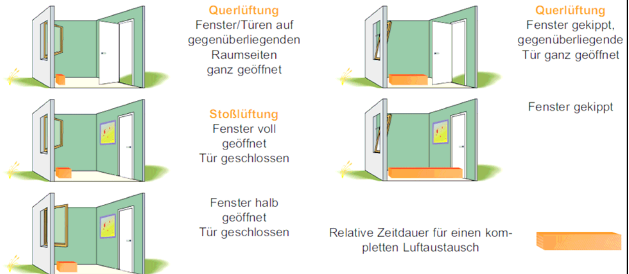
Abb.: Notwendige Lüftungsdauer bei unterschiedlichen Lüftungsarten, um einen Luftwechsel nach außen (Außentür) zu erreichen. Quelle: Energieagentur NRW
